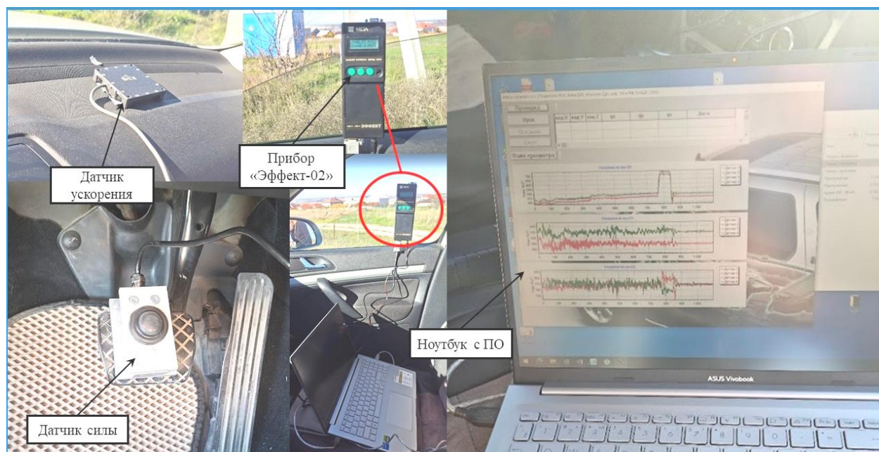
Рисунок 4. Аппаратно-измерительный комплекс при проведении экспериментов.
