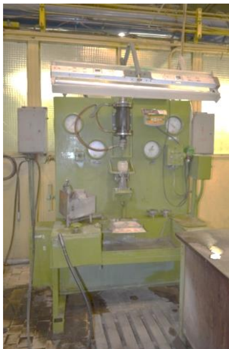
Рисунок 2. Стенд для проведения гидравлических испытаний форсунок на расход жидкости.
