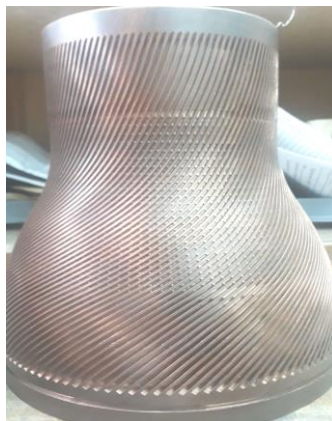
Рисунок 1. Внутренняя оболочка камеры сгорания.
