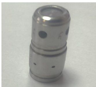
Рисунок 1. Центробежная тангенциальная форсунка жидкостного ракетного двигателя.
