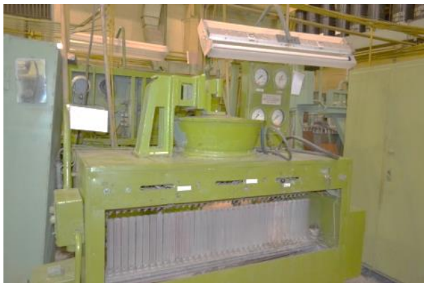
Рисунок 3. Стенд для проведения гидравлических испытаний форсунок на неравномерность конуса распыла.
